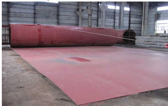
Рисунок 1. Скатывание металла в рулон
