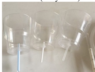
Рисунок 2 – Конструкция соляного маятника с разными размерами трубок
